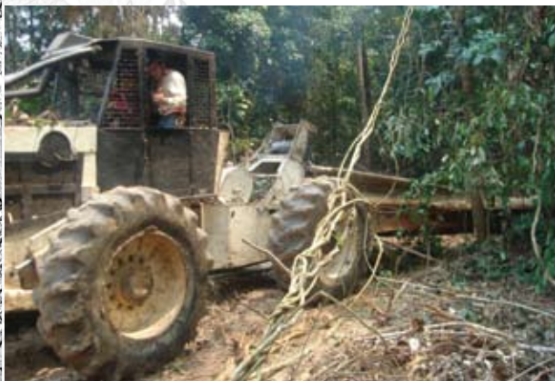
Arraste das toras com Skidder
