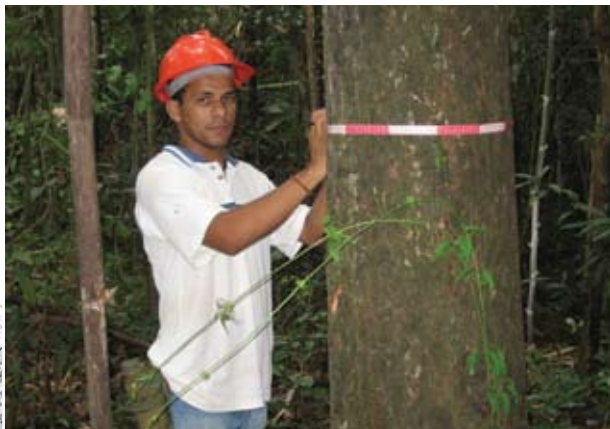
Medição do diâmetro a altura do peito
